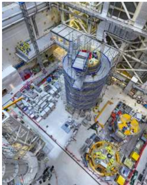
Le solénoïde central sera l'aimant supraconducteur pulsé le plus puissant au monde. Crédit : ITER
