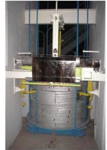
Le sismographe Quervain-Piccard (1936) comporte une masse de 20 tonnes (crédits : OVSM – IPGP)
