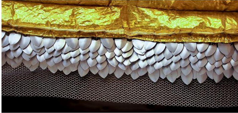
L'élégance médiévale de la jupe extensible du WTS, avec l'isolant thermique doré alourdi par un anneau de cotte de mailles (© NASA/JPL-Caltech/IPGP/Philippe Labrot).
