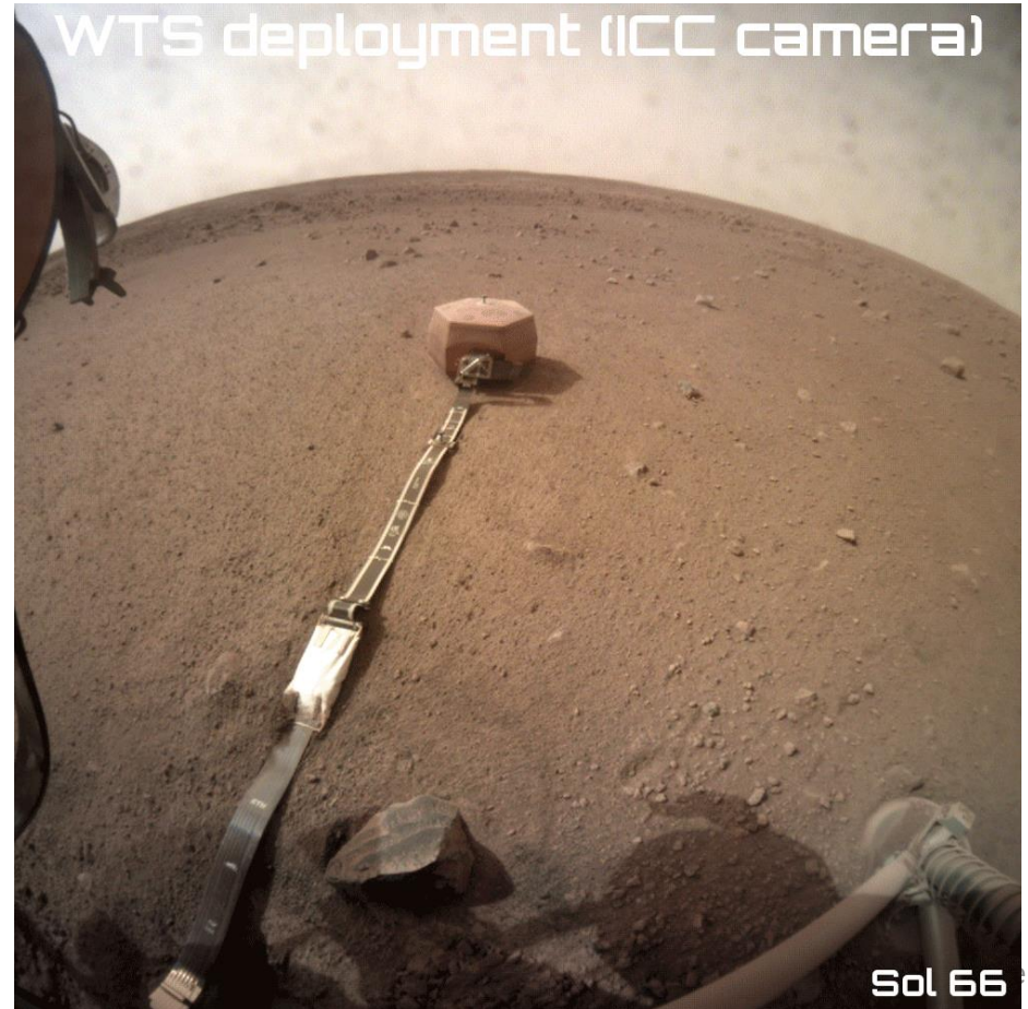
L'élégance médiévale de la jupe extensible du WTS, avec l'isolant thermique doré alourdi par un anneau de cotte de mailles (© NASA/JPL-Caltech/IPGP/Philippe Labrot).
