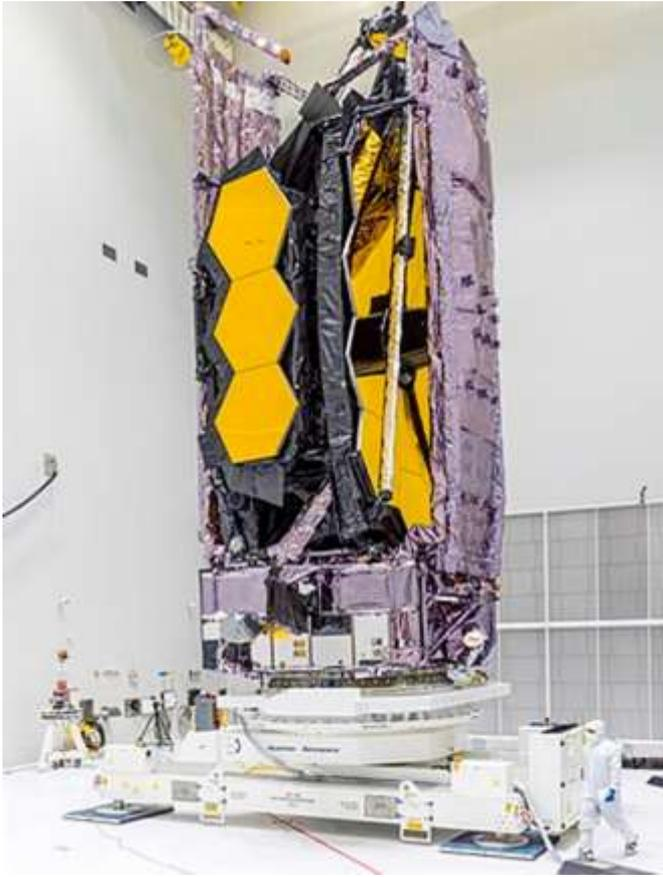
Le JWST entièrement assemblé et en position repliée en [salle blanche](#) à Kourou peu avant son installation sur son lanceur [Ariane 5](#) ; le technicien en bas de la photo donne l'échelle.
